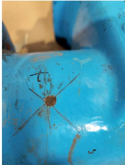
Bild 6: Detailaufnahme der künstlichen Fehlstelle: Keine Korrosion oder Delamination erkennbar
