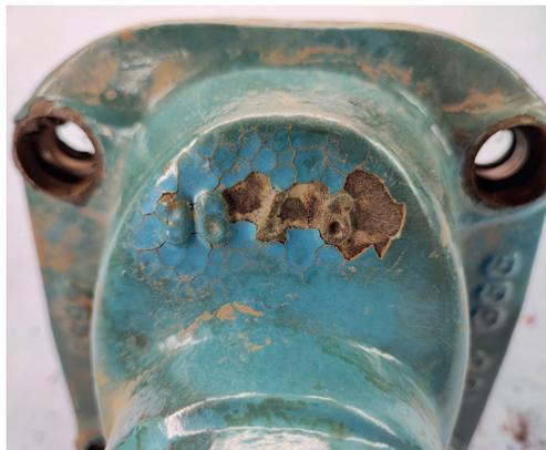
Bild 5: Blasenbildung an der Außenbeschichtung, Rissbildung und Korrosion an der Außenbeschichtung der Haube
