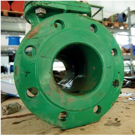
Bild 4: Detailaufnahme eines Schiebers direkt nach Ausbau: keine Korrosion im Innenbereich erkennbar
